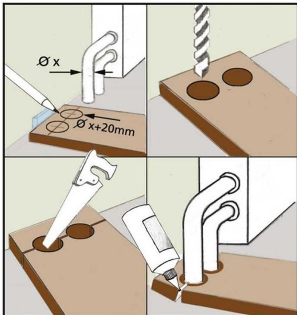
После укладки ламината можно замаскировать зазоры с помощью специальных накладок на трубы. При выпиливании отверстий для обхода иных жёстко закреплённых конструкций также оставляйте расширительный зазор в 10 мм.
