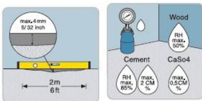
*Важно! Стандартные цементные стяжки высыхают до нужной влажности в течение 1–7 недель, быстросохнущие — за 1–5 дней. Более точную информацию всегда можно узнать у производителей выравнивающих смесей. Уложите на основание слой пароизоляции с заходом на стены в 3–5 см. Нахлест полотен пароизоляции должен составлять не менее 20 см. Стыки полотен проклейте клейкой лентой.*
