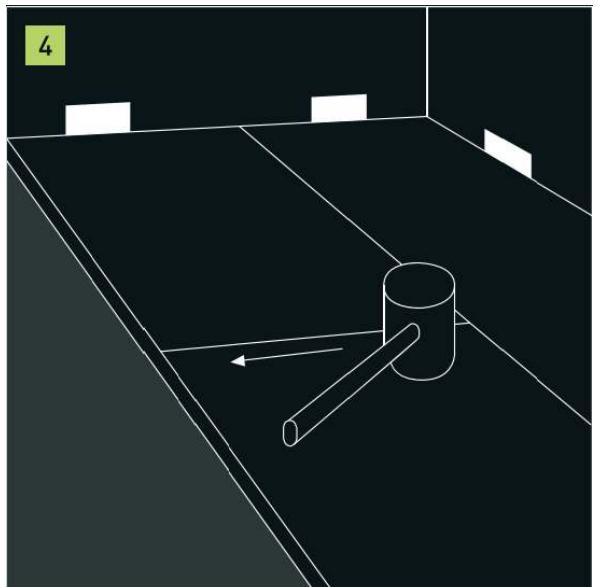
Постучите по верхней части панели вдоль короткого шва, используя прорезиненный молоток.
