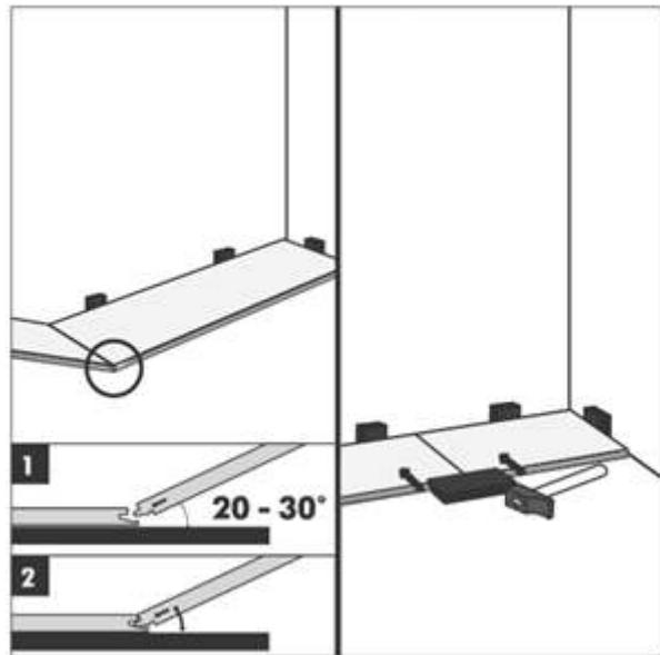
**3.** Продолжайте соединять первый ряд, пока не дойдете до последней целой панели. Установите последнюю панель, повернув на 180 градусов рисунком вверх. Измеряйте и отмечайте, затем, используя линейку и универсальный нож, прорезайте панель по линии отметки и отламывайте. Прикрепляйте, как описано выше (Схема 3).
