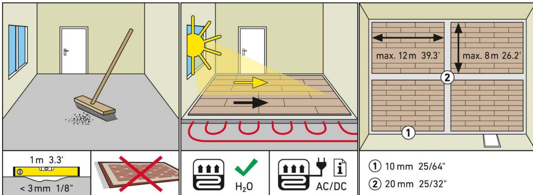
Ламинат KRONOTEX с системой Clic укладывается плавающим способом. Это означает, что панели **не должны приклеиваться, прибиваться или иным образом фиксироваться на полу.**
