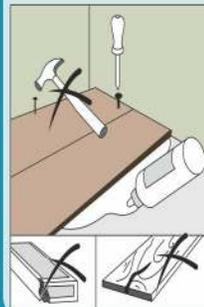
Так как ламинат укладывается плавающим способом, то есть панели ни коем образом не должны быть прикреплены к основанию, соответственно СТРОГО воспрещается жесткое крепление панелей к основанию при помощи гвоздей, шурупов, клея и т.д.
