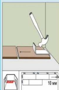
Для монтажа последней доски, прилегающей к стене используется струбцина. Она позволяет без труда осуществить соединение с предыдущей панелью.
