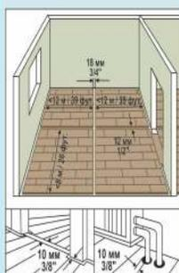
При укладке ламината большими пластинами необходимо помнить, что если площадь укладываемого ламината превышает по длине или ширине 12 м и составляет более 120-150 м², необходимо предусмотреть компенсационные швы минимум 12 мм шириной. В противном случае в полотно ламината начнут образовываться щели и напольное покрытие придет в негодность.
