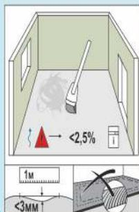
Укладка ламината допустима на линолеум, паркетную доску или иное основание при условии соблюдения требований ровности, прочности и влажности основания для укладки ламината. Не желательна укладка ламината поверх хвойного покрытия из-за эффекта «статического разряда». Если укладка производится на бетонное основание, то относительная влажность не должна превышать 2,5%. Все неровности стяжки, превышающие 3 мм на 1 м.п. должны быть устранены. Основание должно быть чистым, сухим, ровным и прочным.
