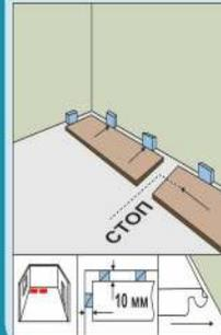
Укладка ламината начинается с формирования первого ряда из 2-ух досок, при этом устанавливаются специальные распорные клинья, обеспечивающие зазор между ламинатом и стеной от 7 до 15 мм. Данные зазоры необходимы для того, чтобы ламинату после укладки не мешала стена расширяться и сужаться. Если Ваш ламинат встал кривым, то очень велика вероятность, что нарушено именно это правило. Ламинат укладывается замком на себя для облегчения защелкивания панелей.
