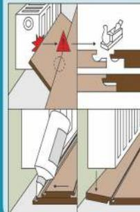
Иногда в укладке ламината возникает ситуация невозможности установки панели из-за помехи. В этом случае необходимо спилить часть замка и закрепить панель при помощи клея для ламината.
