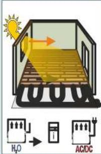
Начните укладку таким образом, чтобы свет из окна падал параллельно швам ламината. В случае перпендикулярного падения света, швы от ламината будут видны более отчетливо. Укладка ламината возможна на основания с водяным обогревом и электрическим.
