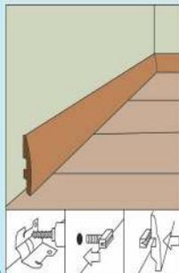
После укладки ламината можно приступить к монтажу плинтуса. Здесь приведена схема крепления плинтуса на клипсах. Обратите внимание - при использовании подложки «BAU MASTER» нижняя часть плинтуса не должна препятствовать оттоку остаточной влажности стяжки.
