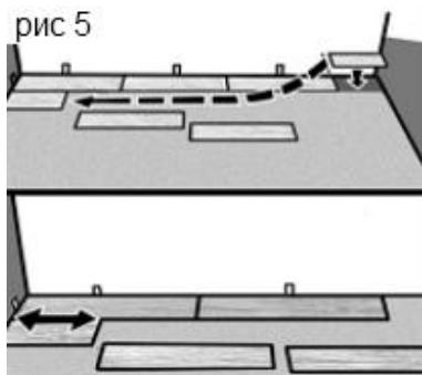
планки, опустите и защелкните. Используйте деревянный брускок и молоток, чтобы закрепить замки по длинным и коротким сторонам планки (Рис. 4(1), 4).
