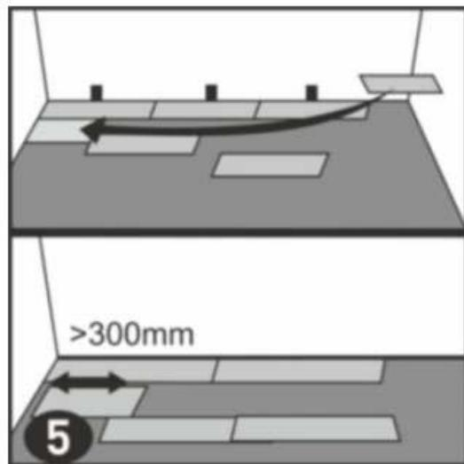
7. Для монтажа второй доски второго ряда, торцевую часть второй ламели разместите под углом 30°, вставьте торцевую часть монтируемой доски в торцевую часть первой. Аккуратно защелкните замок. Соберите второй ряд до конца. После этого аккуратно состыкуйте его с первым рядом
