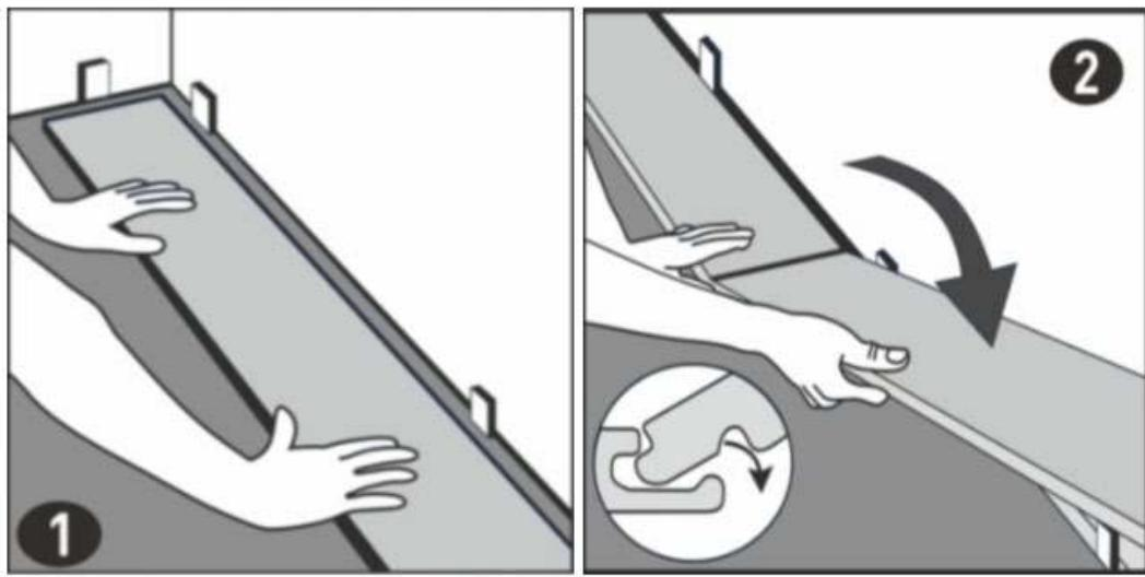
4. В конце первого ряда оставьте расширительный зазор с торца, равный зазору по периметру, и измерьте длину последней доски.
