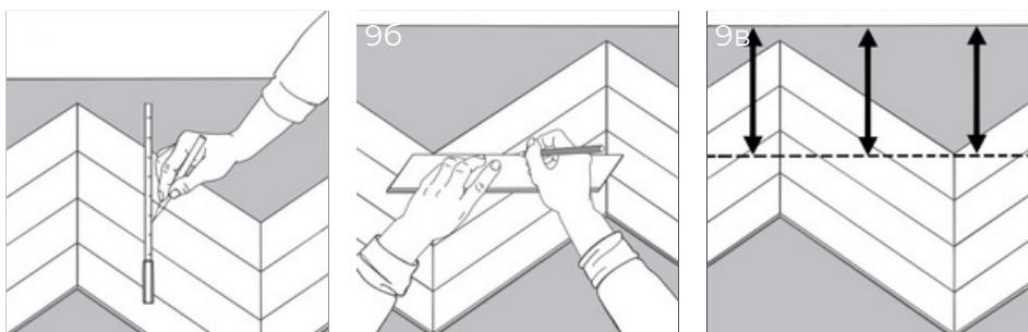
10. Пронумеруйте панели, это позволит вам сохранить порядок. Разберите панели и разрежьте их по размеру, по линии, отмеченной в предыдущем шаге.
