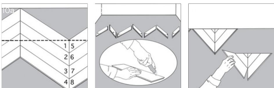
12. Установите распорные клинья между полом и стеной, чтобы оставить зазор 8 мм. Соедините треугольники путем добавления нескольких дополнительных линий из планок. Начинайте каждую линию слева направо, а заканчивайте нарезанными панелями как в шаге 5.
