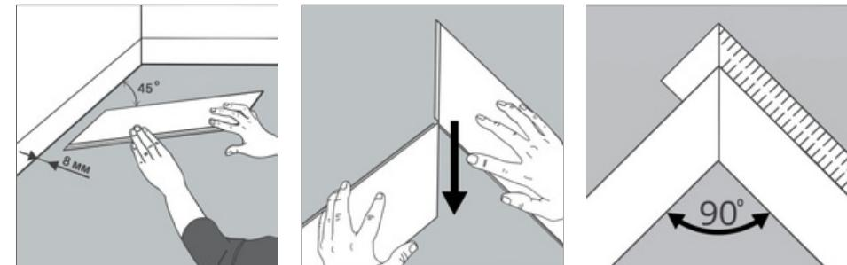
2. Следующая панель – А. Присоедините её короткой стороной к углу короткой стороны предыдущей панели В, проверяя внешние углы строительным треугольником. Продолжайте аналогично, подсоединяя столько панелей, сколько поместится вдоль стены, параллельно которой вы начали укладку ряда.
