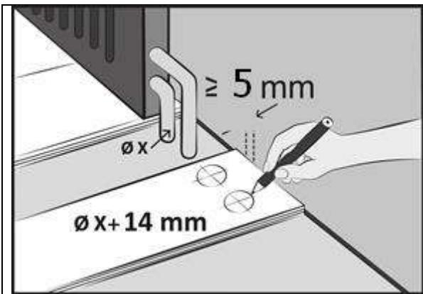
При укладке тупых углов, вокруг труб или сложных профилей нужно отметить форму на доске и вырезать по контуру.
