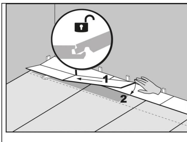
Далее следующую плитку соединяем по короткой стороне таким образом, чтобы шип по длинной стороне лёг поверх паза плитки предыдущего ряда, затем приподняв на 20 градусов обе планки сдвигайте последнюю плитку до полного защёлкивания замка по длинной стороне с плиткой предыдущего ряда. Таким же образом соединяем все последующие плитки.
