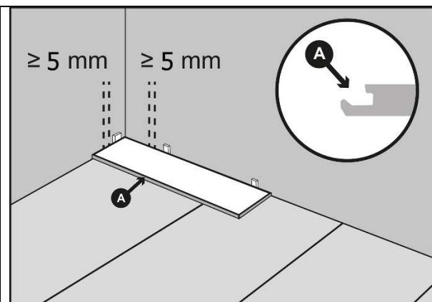
Укладка плитки осуществляется последовательно слева направо двигаясь на себя. Обычно выбирают тот угол комнаты (от которого начнется укладка), к которому плитка прилегает шипами короткой и длинной стороны. Укладываются «шип-в-паз»
