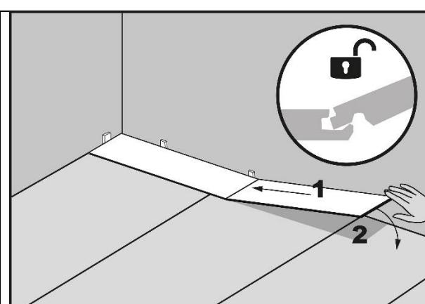
Вставляем короткий край следующей доски под углом примерно  $20^\circ$  к первой и опускаем. Соединенные доски должны быть уложены точно в линию
