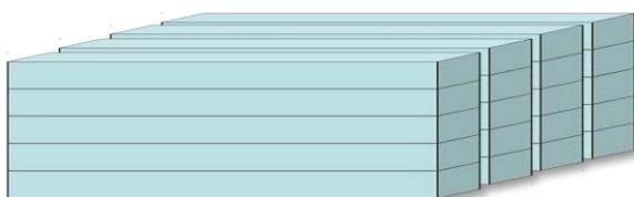
ART STONE FORCE должен акклиматизироваться в помещении, где производится установка, не менее чем за 48 часов до установки или до тех пор, пока материал не достигнет температуры окружающей среды: это минимальная температура 18°C и максимальная 27°C.
