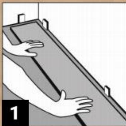
После тщательной подготовки и очистки основания чернового пола можно начинать укладку первого ряда. Движение ряда должно располагаться слева направо. Первая доска должна быть расположена таким образом, чтобы замковой паз находился в направлении укладываемого. Доска должна находиться на расстоянии 6 мм от стены. Используйте колышки для удобства фиксации. В конце первого ряда оставьте расширительный зазор 6 мм с торца и измерьте длину последней доски.
