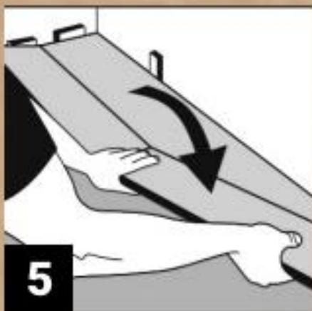
Для монтажа второй доски второго ряда, торцевую часть второй ламели разместите под углом  $30^\circ$ , вставьте торцевую часть монтируемой доски в торцевую часть первой. Аккуратно защелкните замок. Соберите второй ряд до конца. После этого аккуратно состыкуйте его с первым рядом
