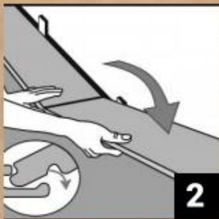
Монтаж второй доски первого ряда осуществляется следующим способом: под углом 30° вставьте торцевую часть монтируемой доски в торцевую часть первой. Аккуратно защелкните замок. Используя резиновый молоток, подстучите ламель, чтобы обеспечить полную сцепку досок на одном уровне высоты.
