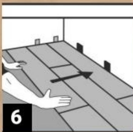
После установки двух-трех первых рядов, необходимо убедиться в ровности направленности рядов. Если ряды досок лежат под небольшим углом, это может означать, что стена, от которой была начата укладка, имеет определенные неровности, что и приводит к смещению геометрии всего пола. В этом случае придется разобрать уже уложенные ряды и начать заново, подрезав доски первого ряда согласно соосности стены
