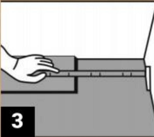
В конце первого ряда оставьте расширительный зазор 6 мм с торца и измерьте длину последней доски
