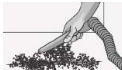
Рис. 8. После высыхания удалить избыток песка при помощи пылесоса
