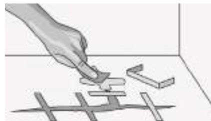
Рис. 5. Уложить скобы в поперечные шлицы. Залить смолой трещины. Если трещины широкие, необходимо добавить крупнозернистый песок
