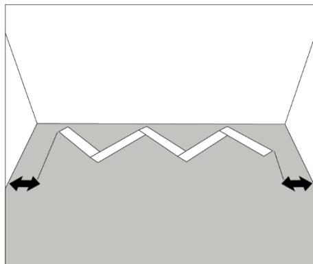
5. Вырежьте торцевые планки по размеру. Измерьте и отрежьте торцевые планки по размеру с помощью пилы с мелкими зубьями. Закончите первый ряд с помощью обрезанных торцевых планок. Убедитесь, что вы оставили зазор в 10 мм до каждой стены.
