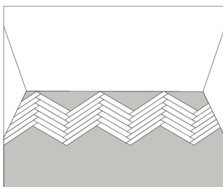
10. Отрегулируйте начальные ряды. Первые четыре ряда должны быть установлены параллельно стене. Измерьте и отметьте, где нужно отрезать планки на фиксированном/параллельном расстоянии от стены.
