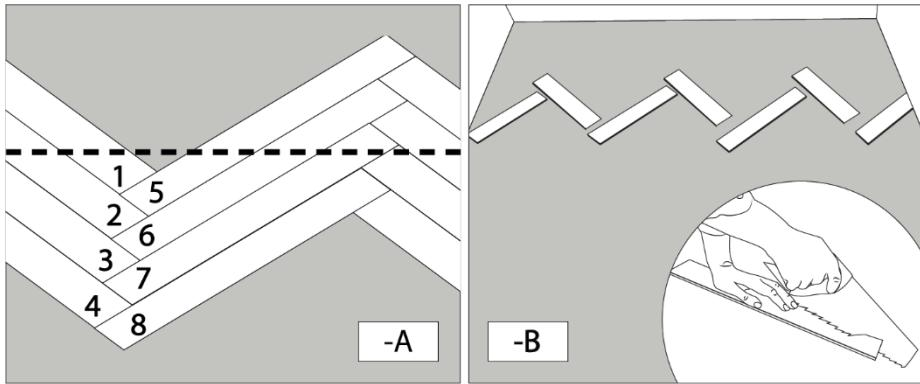
Альтернативный способ укладки первых рядов. Оставьте левые торцевые панели неустановленными. Наклейте ленту вдоль отмеченной линии на планках от стены и положите первые четыре ряда поверх нескольких упаковок напольного покрытия. Разрежьте плитки вдоль отмеченной линии. Затем уложите отрегулированные ряды на место. Завершите первый ряд установкой оставшихся торцевых планок. Начните с торцевой планки в последнем ряду и закончите первым рядом.
