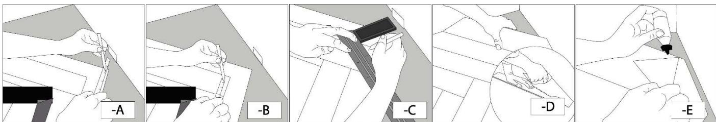
17. Уберите распорки и закройте расширительный зазор плинтусами или рейками.
