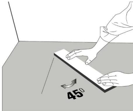
2. Подсоедините следующую планку (планкой В). Вставьте длинную сторону В-планки под углом к короткой стороне предыдущей установленной планки А. Соедините В-планку и, чтобы плотно зафиксировать планки вместе. Убедитесь, что шип и паз на двух планках образуют непрерывную линию.
