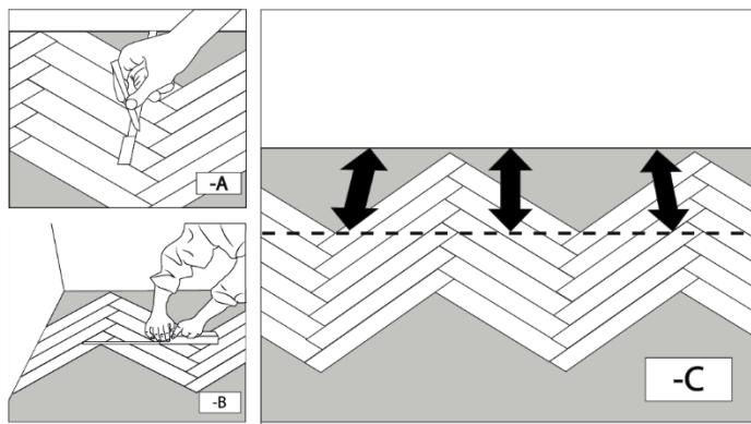
11. Демонтируйте планки и разрежьте их. Пронумеруйте планки от 1 до...., чтобы сохранить порядок расположения планок. Демонтируйте планки и отрежьте их по размерам вдоль ранее отмеченной линии.
