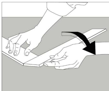
3. Соедините дополнительные планки. Следующая планка — это планка А. Снова вставьте длинную сторону новой А-планки под углом к короткой стороне предыдущей В-планки и соедините. Продолжайте таким образом с таким количеством плиток, которое могут поместиться вдоль начальной стены.
