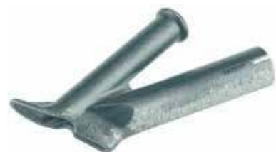
Насадка для быстрой сварки прутком 4-5мм с зауженным выходом воздуха. Применяется для сварки ПВХ покрытий шнуром диаметром 4-5 мм. Одевается на сварочный аппарат через стандартную насадку
